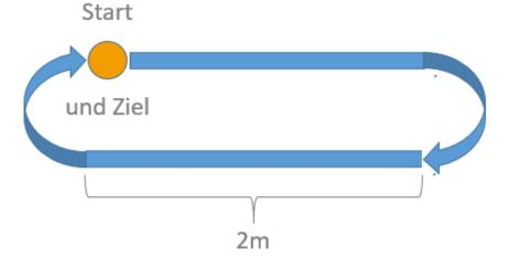
Ändere den Code, damit er eine Kurve fährt (s. o.) und passe die Zeit vom letzten delay an, sodass eine 180° Kurve gefahren wird. Passe die Zeit vom ersten "delay" an, sodass 2 Meter gefahren werden.
