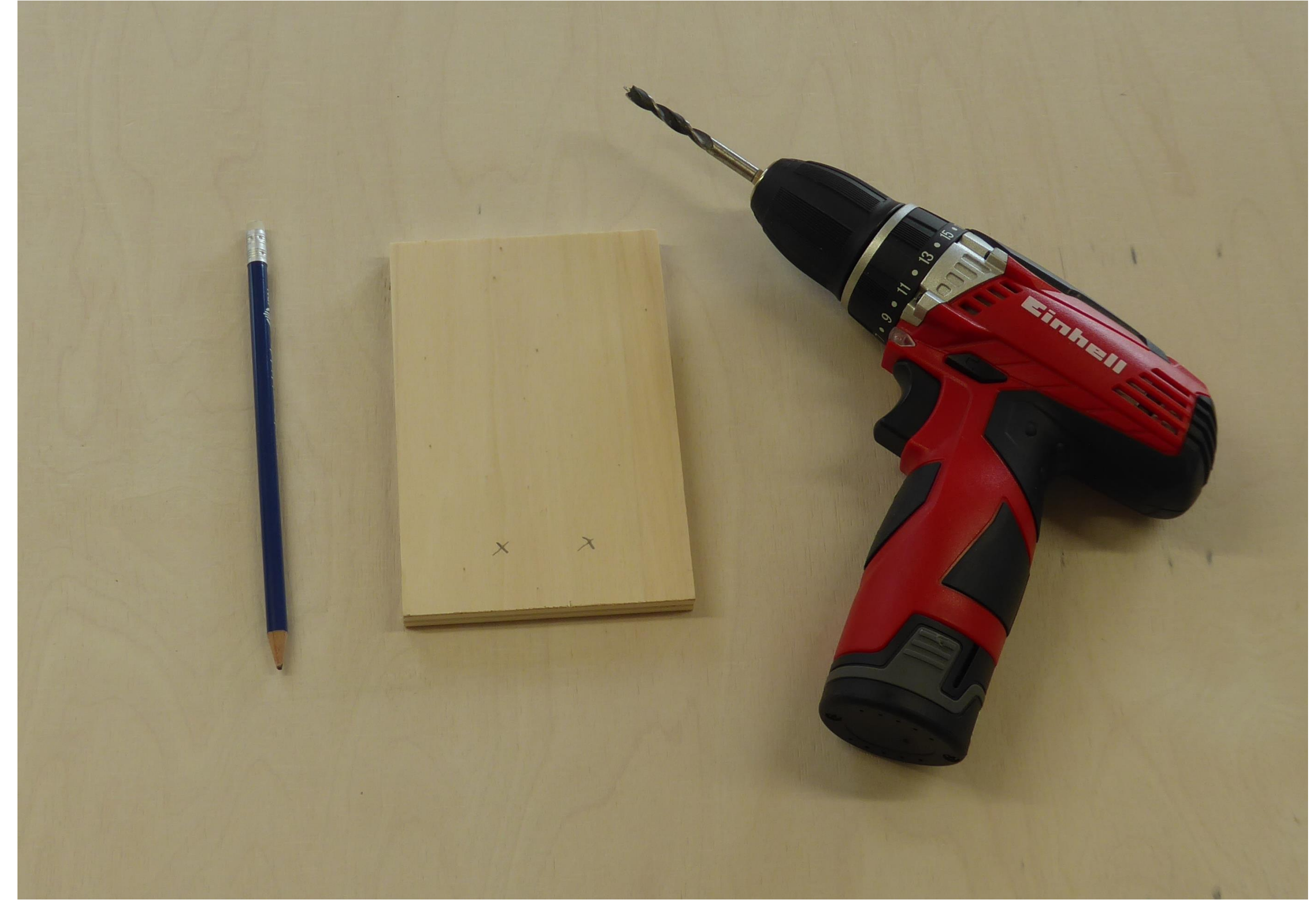
1. Bohren von 2 Löchern für die Motorenkabel.
